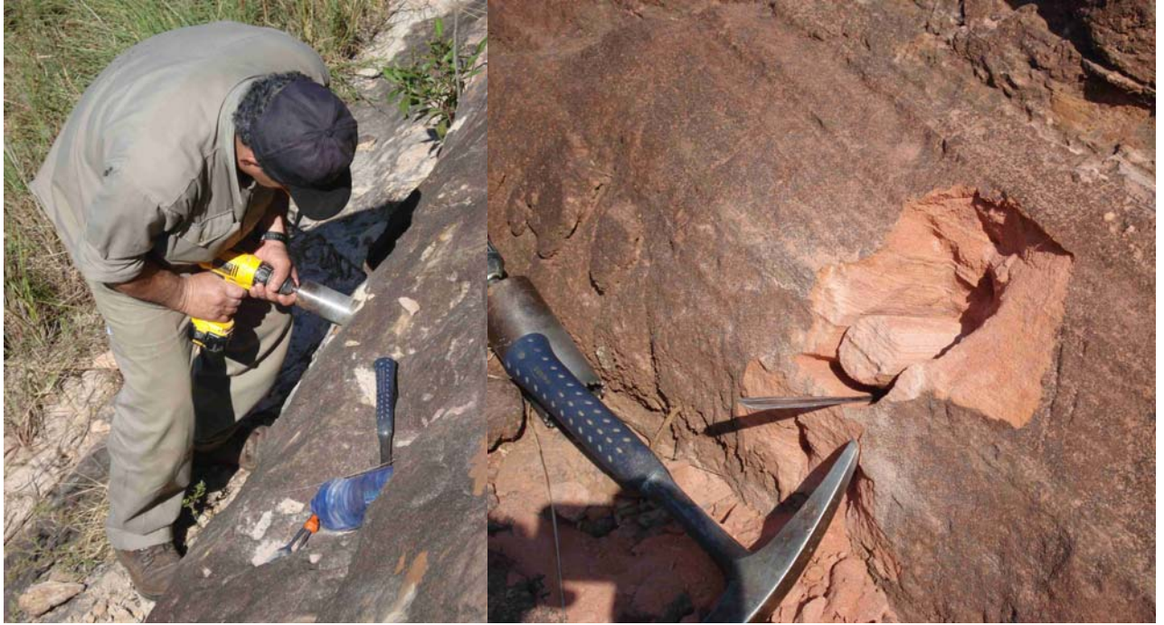
Figura 16. Metodología de obtención de muestras mediante el uso de un taladro eléctrico provisto de una broca. Izquierda: El muestreador Sr. Mario Navarro en acción. Derecha: vista del núcleo obtenido antes de su extracción.
