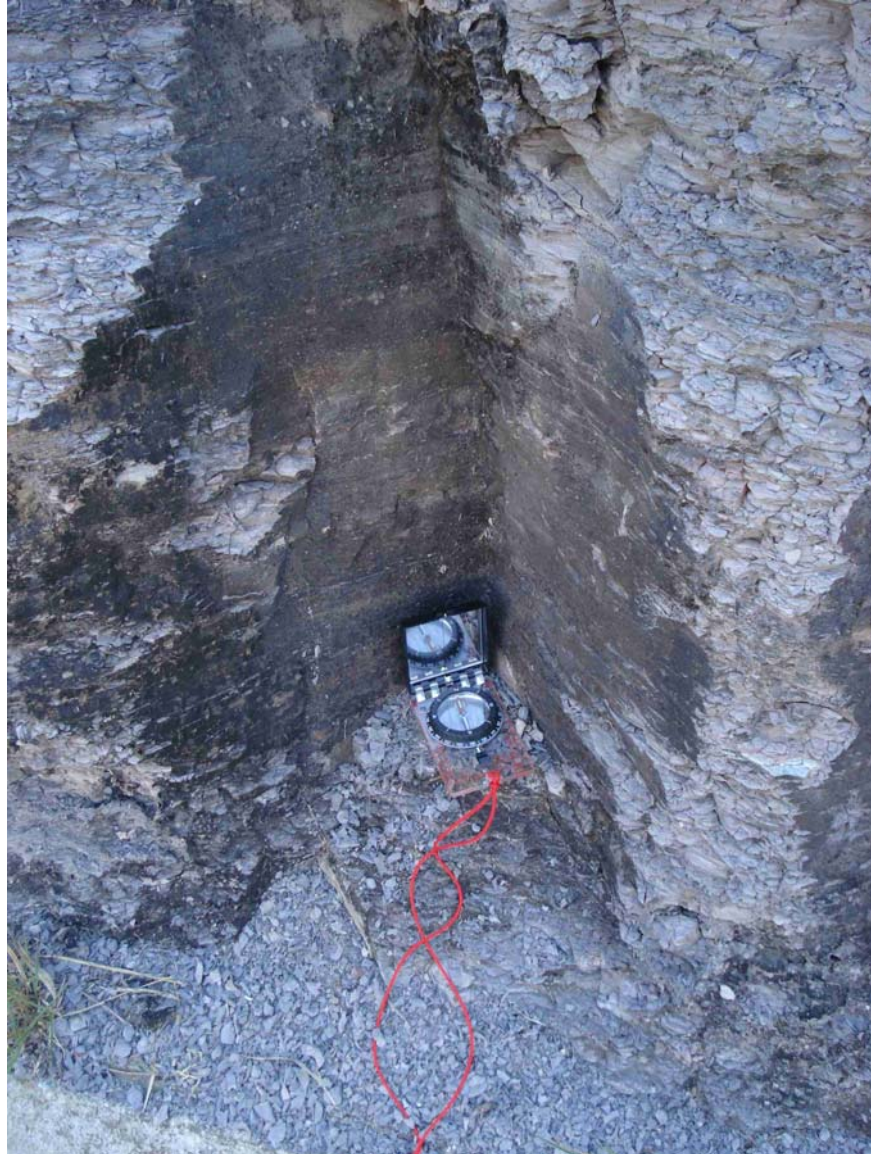
Figura 10. Vista de los afloramientos de la Formación Teresina superiores (a la altura de Kilómetro 160), donde se aprecian los dos juegos principales de fracturas que pueden ser conjugados.
